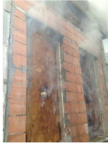
- Detalle muestra después del ensayo. Cara no expuesta -
